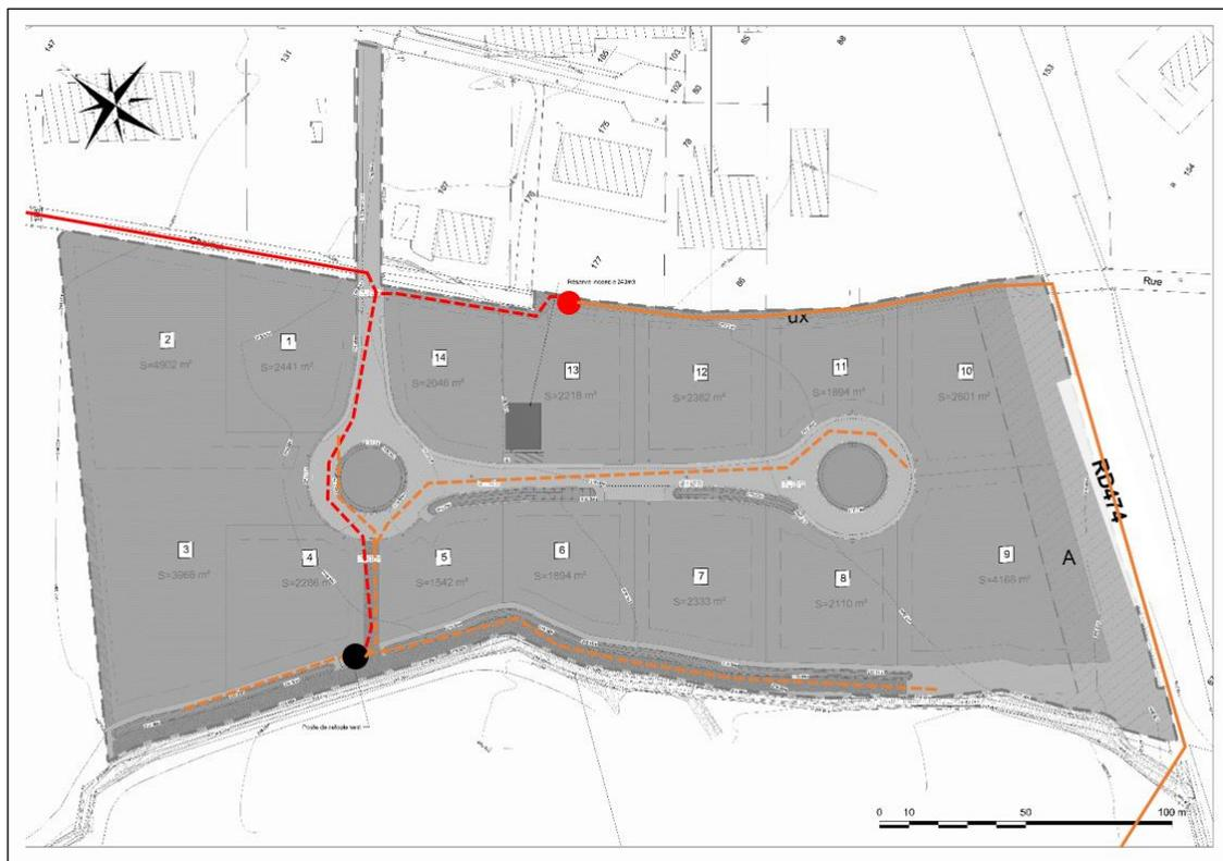
Figure 18 : Schéma du réseau d'eaux usées
