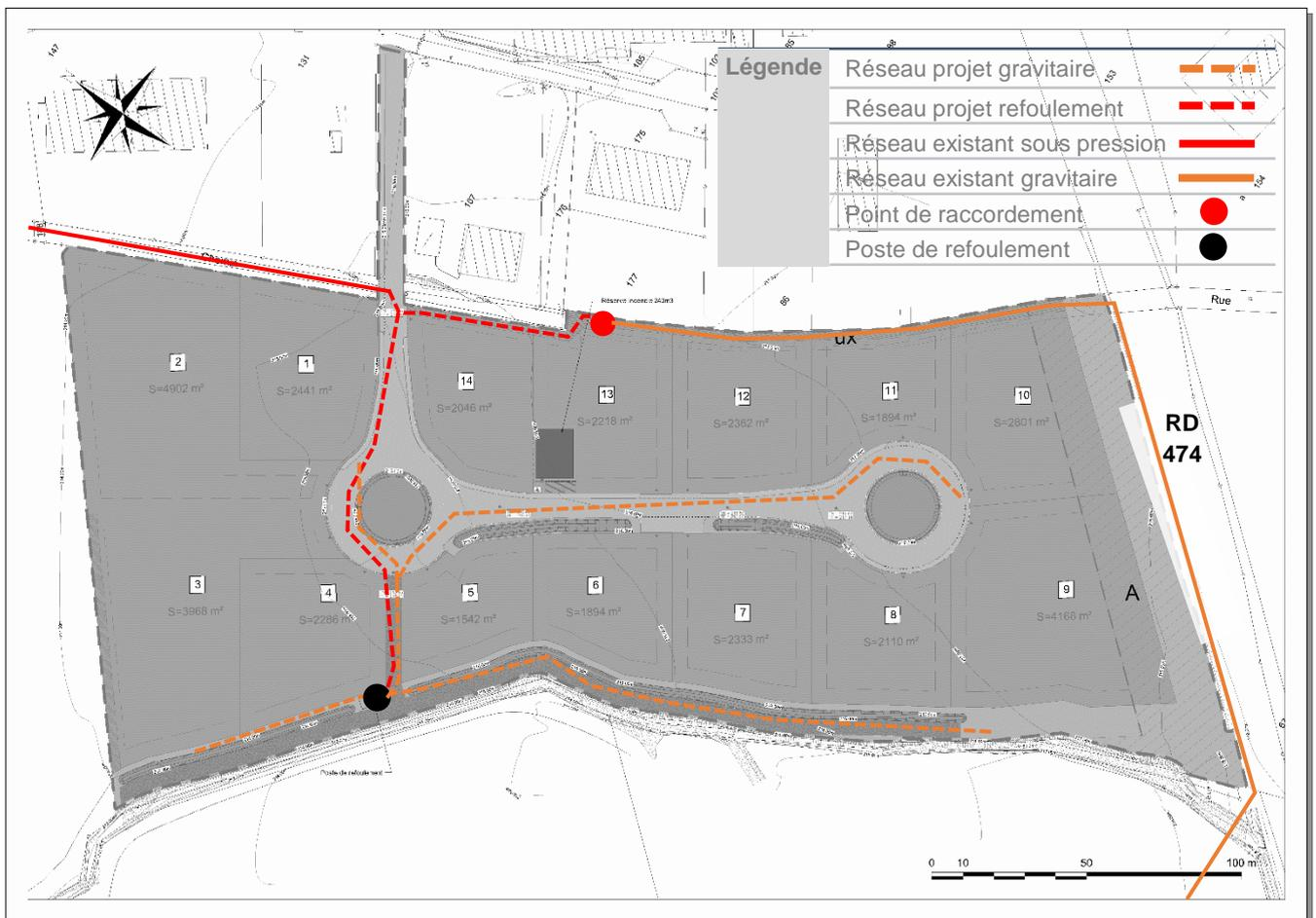
Figure 8 : Schéma du réseau d'eaux usées
