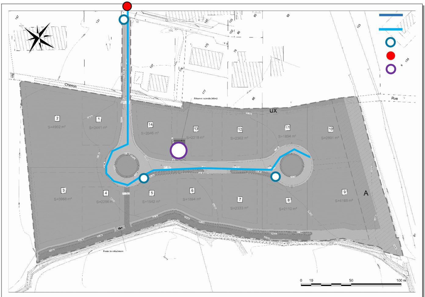
Figure 9 : Schéma du réseau d'eau potable
